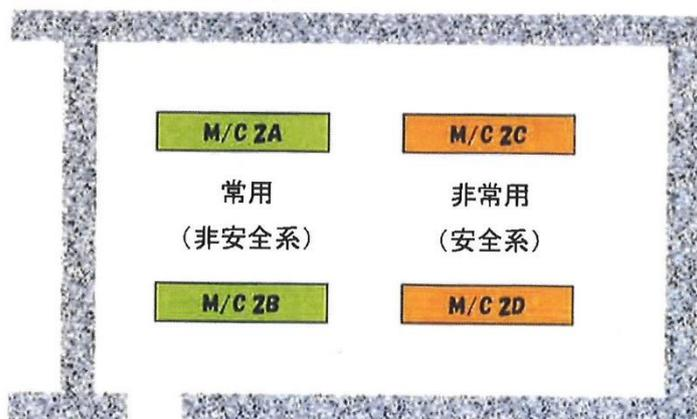
◎ 2号機の安全系の電源盤（交流480V系）の配置状態
