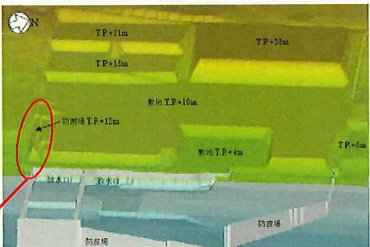
主要建屋敷地高を上回る波高が確認される敷地南側にのみ高さT.P.+12mの防潮堤を設置し、ドライサイトを維持する津波対策を行う
