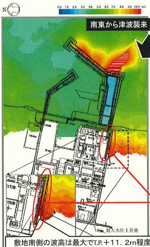
津波評価技術を用い、三陸沖を波源域とする昭和三陸地震(1933)の痕跡高を説明できる断層モデルに慶長三陸地震(1611)のMw8.6を適用し、南東方向から襲来する津波を想定津波として検討
